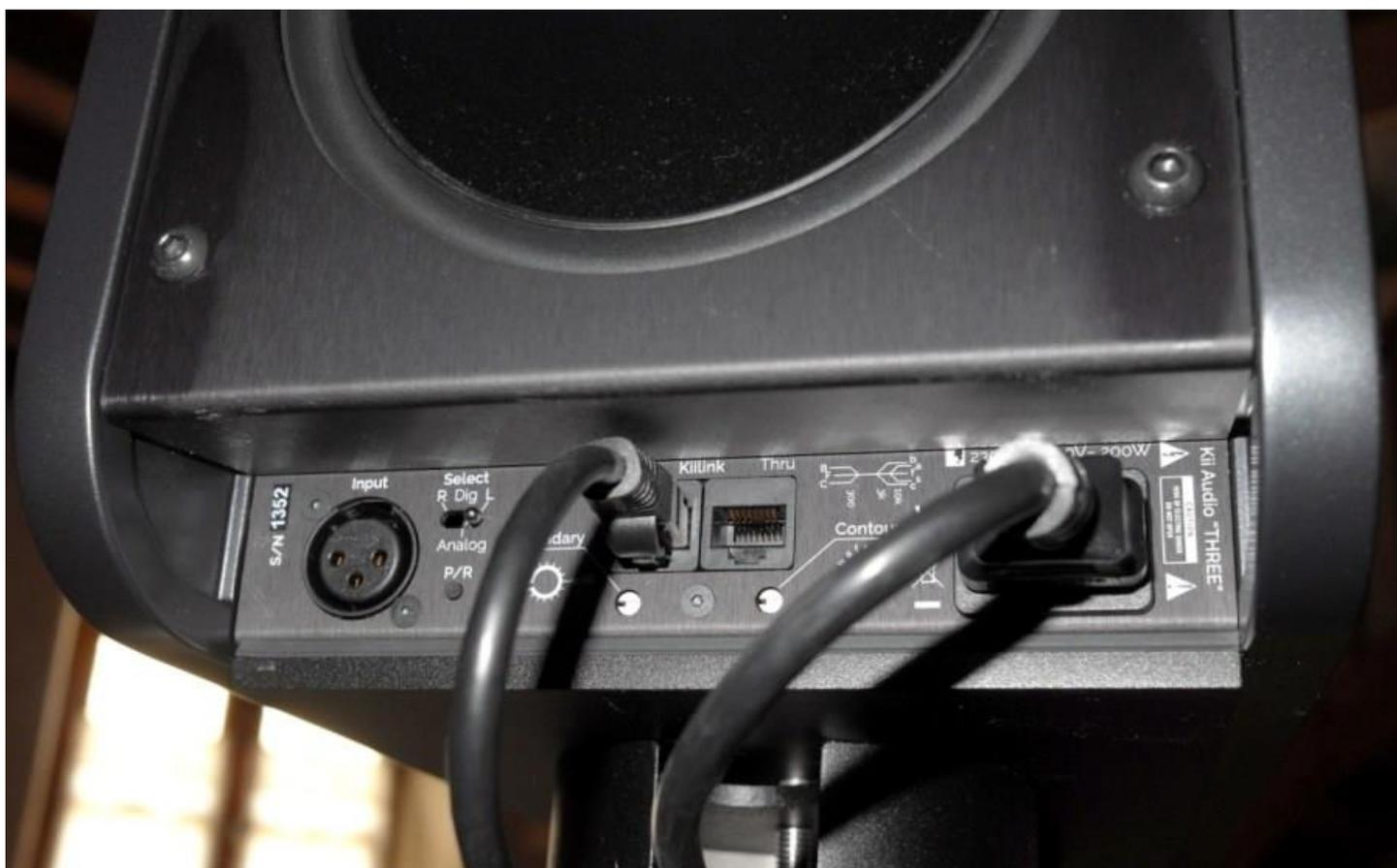
Ce DSP paramétrable possède un contrôleur à distance (le Kii CONTROL) qui permet d'effectuer plusieurs réglages en intervenant sur le filtrage des haut-parleurs.
